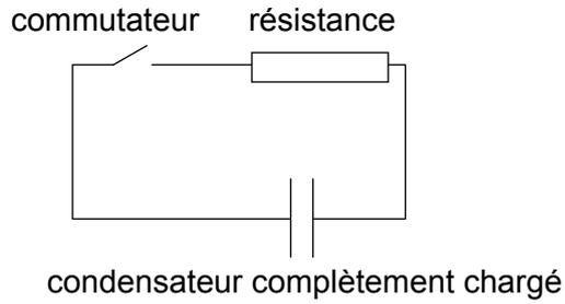
Quels graphiques montrent correctement comment la charge sur le condensateur et le courant dans le circuit varient en fonction du temps pendant la décharge du condensateur ?
